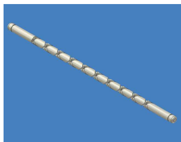
Etape 4 : construction de la seconde hélicoïdale inversée
